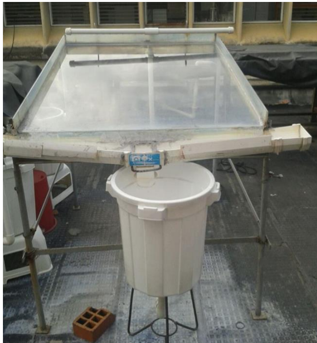
Figura 1. Reactor Solar de placa Plana, Universidad del Valle. Dimensiones 0.98x100 cm.
