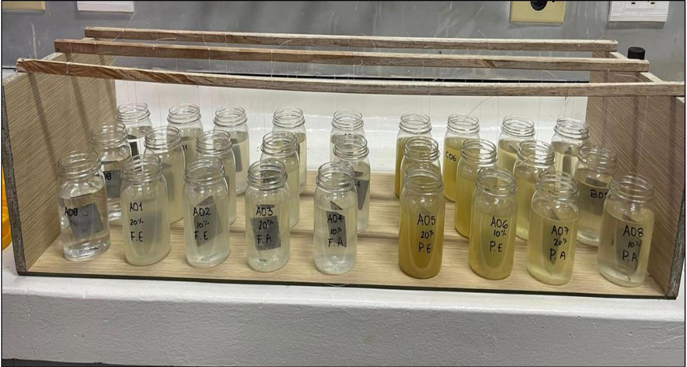
**Figura 2.** Montaje experimental de la prueba de pérdida de peso.
