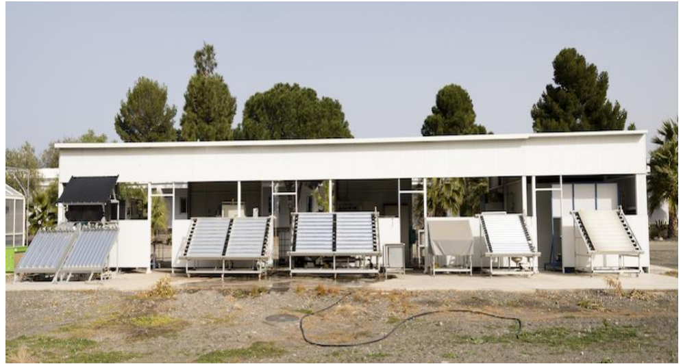
Figura 1. a) y b) Vistas generales de los fotorreactores tipo CPC disponibles en las instalaciones del grupo de investigación TSA en PSA (Tabernas, Almería, España).
