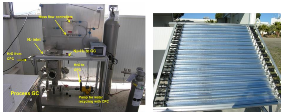
Figura 3. Reactor para producción fotocatalítica de hidrógeno a partir de agua residual a escala planta piloto disponible en las instalaciones del grupo de investigación TSA en PSA (Almería, España).
