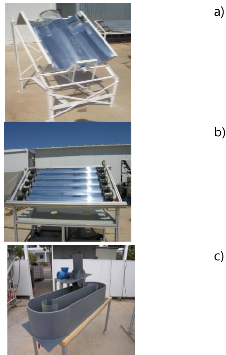
Figura 5. a) Reactor CPC estático de 25L; b) Reactor CPC de flujo en discontinuo de 60L; c) Reactor tipo Raceway que operará en modo continuo de 90L. Todos estos fotorreactores están disponibles en las instalaciones de TSA en PSA (Tabernas, Almería, España).
